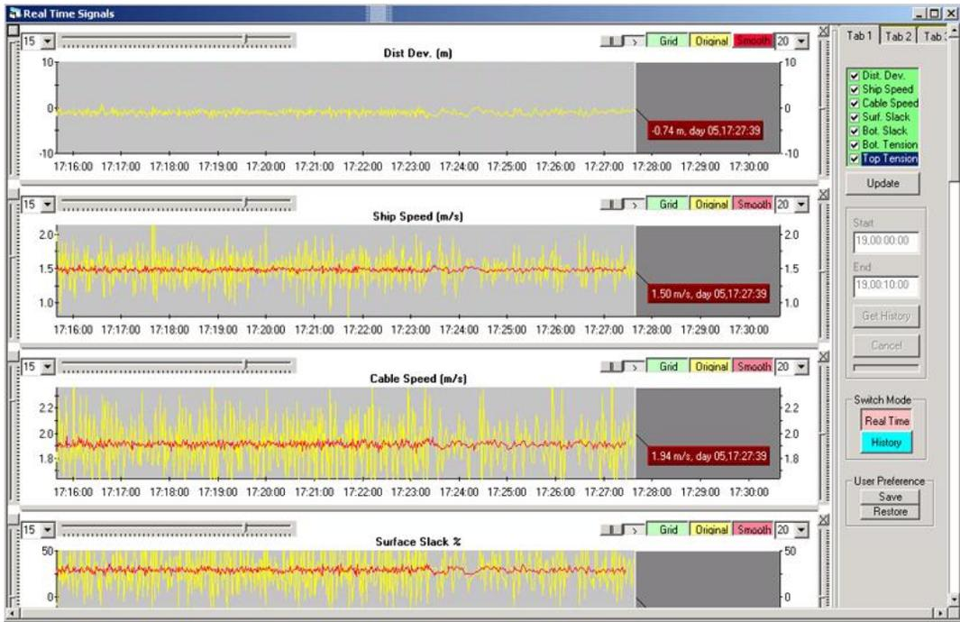
ケーブル敷設作業が詳細で適切な操船プランに正確に従って行われたなら、何故リアルタイム管理が必要になるのでしょうか？ 元来、如何なる敷設作業もプラン通りに進行する事はないし、多くの場合最初のプランから大幅に逸脱します。船速がプラン通りという事はあり得ないし、同様にケーブル繰り出しも完璧にプラン通りにいく事はありません。しばしば予定外の休止があり、不測の事態に遭遇します。機器の故障や天候などが当初の予定を大きく変更します。一旦敷設船の状態が予測に相違したら、一体ケーブルはどう扱えば良いのでしょうか？
